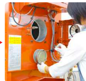
9 掃除口蓋や煙室蓋などは元通りにしっかり締め付ける
