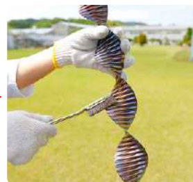
3 スクリュープレートをワイヤブラシで掃除する
