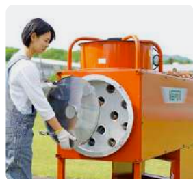
1 煙突を取り外し、煙室蓋、煙室パッフルを取り外す
