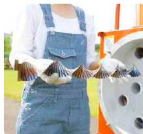
7 焼損したプレートは熱効率を低下させるため新品と交換する
