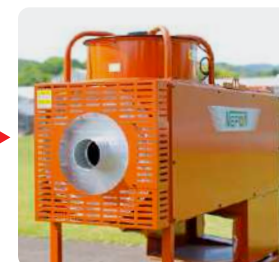
10 掃除が完了したら全て元通りにし（煙突も戻す）終了後試運転を行う
