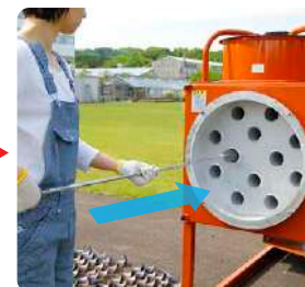
4 燃焼室のすずを掃除棒（ワイヤブラシ）で押し出す
