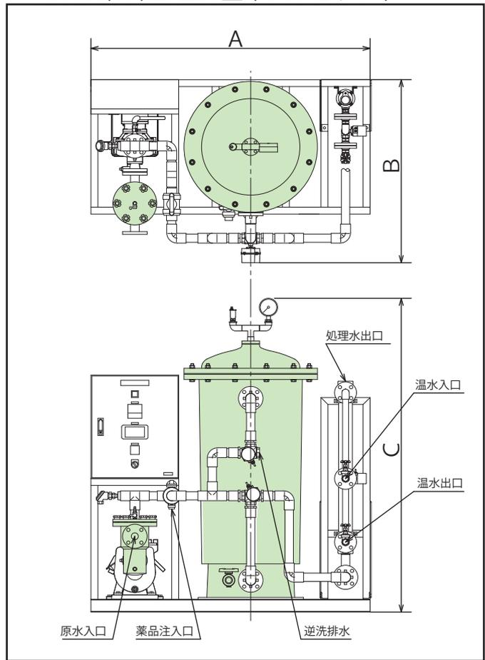
■仕様・寸法表: NX-HA(OH)Ⅰ-□N型 HA: 電動三方弁 OH: 手動三方弁
