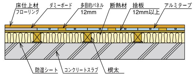
※床仕上材は床下地に確実に止められる長さの釘(またはステーブル)を使用して下さい。(40~50mm)
