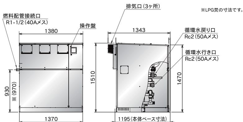
●燃料配管は左側面から右側面への変更ができます。
