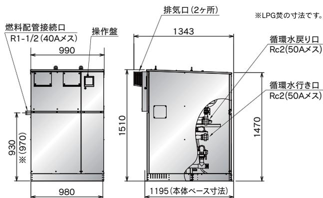
●燃料配管は左側面から右側面への変更ができます。
