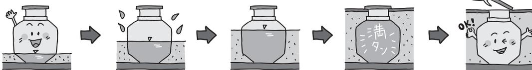
●据え付け2~3日後、タンクの中に水があるか確認してください。タンクに破損がないかの確認のためです。
