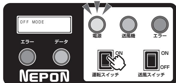
◎省エネハイブリッド制御盤 (NT-602) からの信号によって、自動で暖房・冷房・送風運転します。
