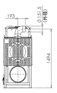
注記 1.温風吹出口の向きは、前後または左右側面方向に付け替えできます 2.煙突接続口は本体左右より取り出すことができます
