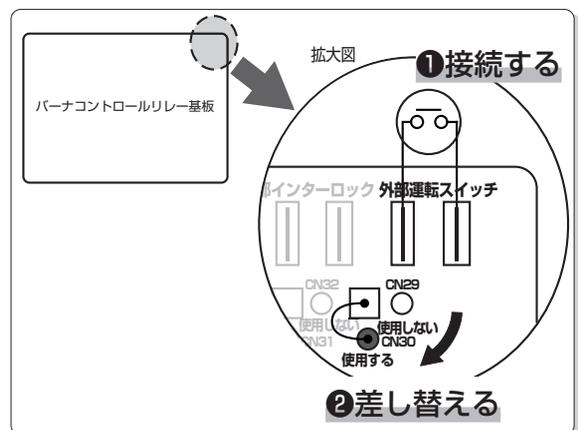
最初に運転するときは、電源コンセントを入れ、外部運転スイッチを「閉」にしてからリモコンの「電源スイッチ」を押してください。
