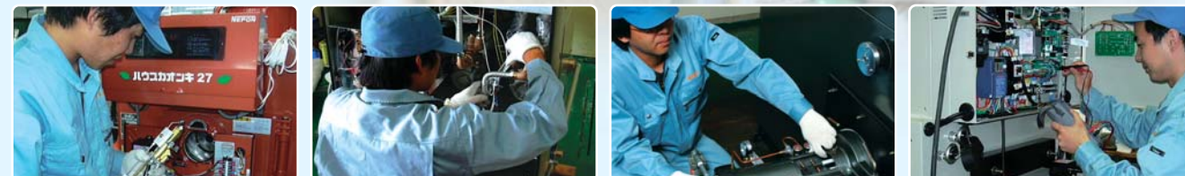
●ハウスカオンキ/バーナ点検・整備 ●シャンプーエース/ポンプ点検・整備 ●シンクロヒータ/バーナ点検・整備 ●シンクロヒータ/制御部点検
