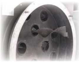
スクリュープレートはハウスカオンの熱交換を促すための大切な部品です。しかし長年使用すると・・・これでは効率はガタ落ちです。
