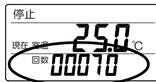
「燃焼回数」表示画面 中段：現在室温 下段：燃焼回数
